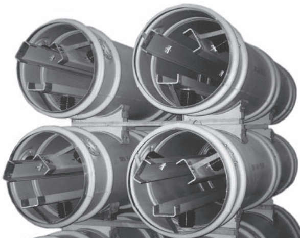
Рис. 18. Внешний вид токопровода ТЗК-10-3150-128 УХЛ 1. Прямолинейные секции в процессе упаковки.
