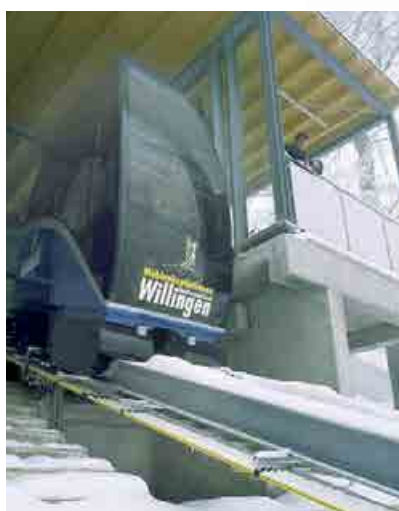
Мы поднимаем вверх! Монополюсные силовые шинопроводы программы 0812 применяются в подъёмных дорогах для подъёма людей на лыжный трамплин.
