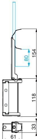
**Отводной блок и отводной блок с изолятором**
