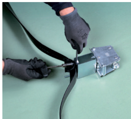
Установка буксирующей тележки RG3506.
