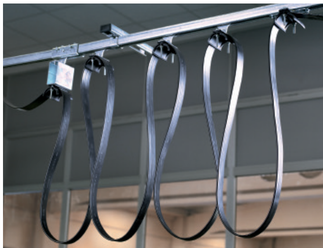
Тележки вручную протягиваются по длине всей линии, проверяя правильность горизонтального выравнивания линии. Если уровень линии выведен правильно то скольжение будет ровным и плавным.
