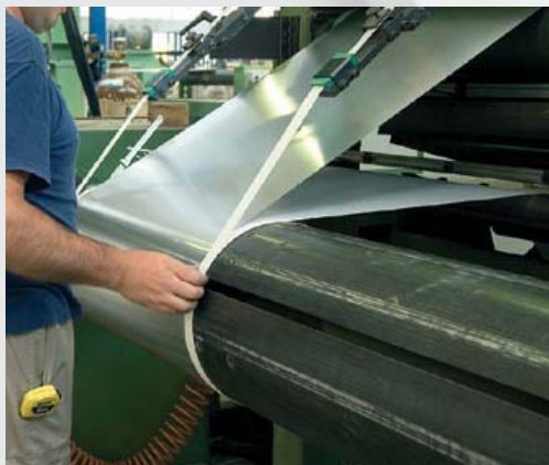
Намотка обмотки низкого напряжения
