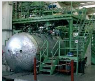
Заливка смолы в глубоком вакууме
