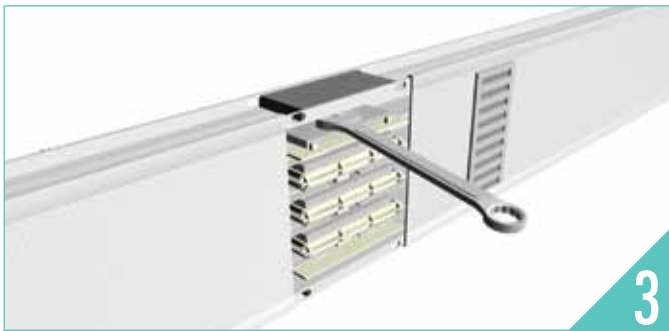
3) Ek elemanı civatasını, tork anahtarını ile belirtilen değerde sıkınız. 3) Tighten joint elements screw with torque wrench according to specified value. إحكام برغي عناصر الوصلات بربط حلقة الإحكام وفقاً للقيمة المحددة
