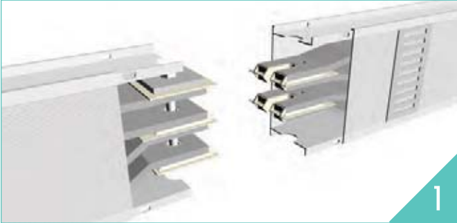
1) Busbar elemanları, ek noktalarını birleştirerek yerleştiriniz. 1) Position Busbar elements with uniting joint points. أغطية تجميع جانبية لنقاط الوصلات
