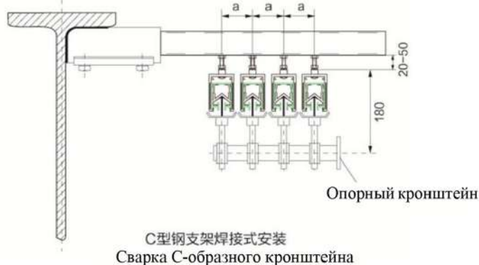
Горизонтальная работа силового агрегата (приварка к угловому стальному кронштейну)
