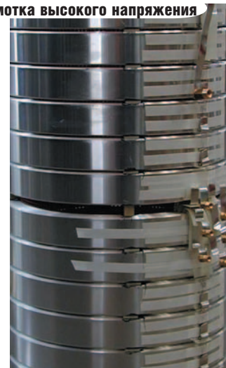
Обмотка высокого напряжения
