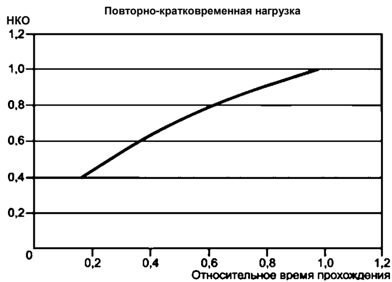
Рисунок Е.8 — Графический пример соотношения между эквивалентным НКО и параметрами при повторно-кратковременном режиме I_1 = I_2 (без пускового сверхтока)
