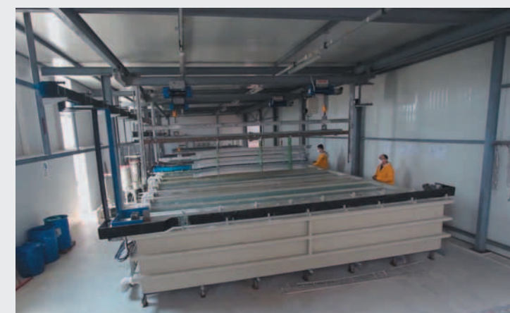
Процесс покрытия проводников оловом
