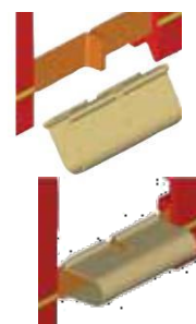
Установка коннектора Cu-C
