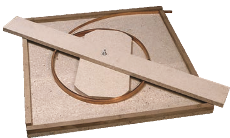
Кассета для соединения проводников ТВ
