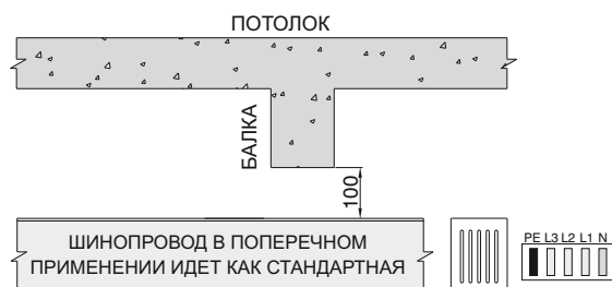
РИСУНОК 4 - ПЕРЕСЕЧЕНИЕ ПОД БАЛКОЙ А В ПОПЕРЕЧНОМ ПРИМЕНЕНИИ
