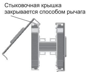
Стыковочная крышка закрывается способом рычага
