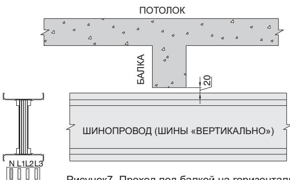
Рисунок 7. Проход под балкой на горизонтальном участке (шины «вертикально»)
